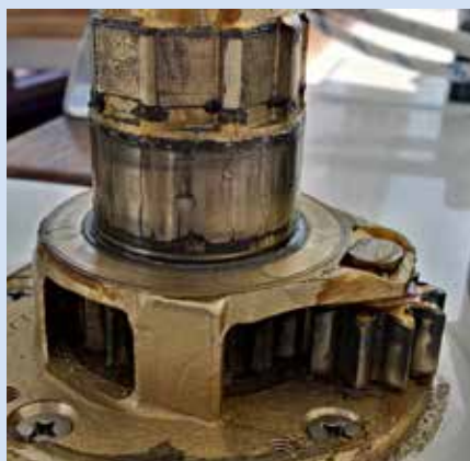
Stark anfällig für Verschleiß und Umwelteinflüsse: Winsch gefettet mit handelsüblichem Mehrzweckfett.
